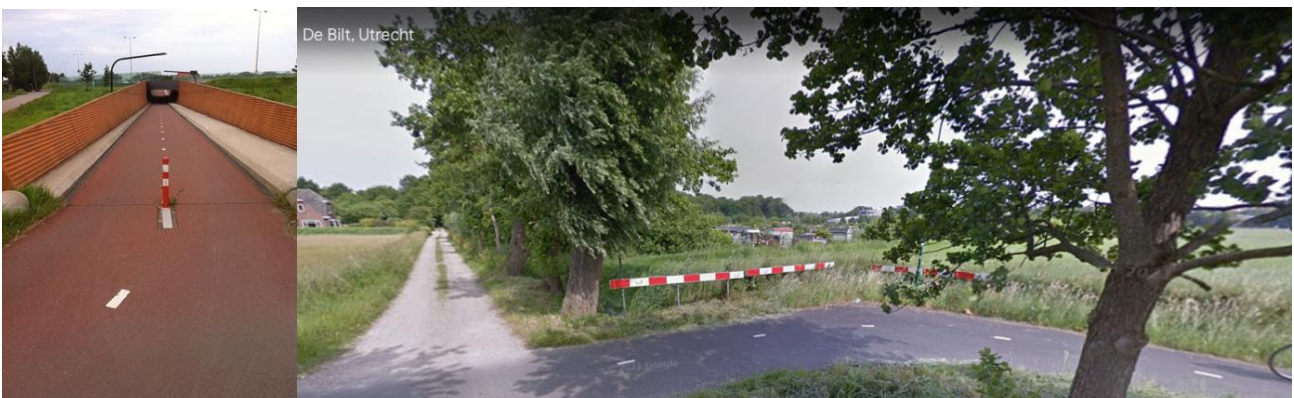
Figuur 7. Links: Rood-wit gestreepte paaltje valt weg tegen de achtergrond. Inleidende ribbelmarking is noodzakelijk om de waarneembaarheid (zien en voelen) te vergroten. Rechts: Haakse bocht aangegeven met contrasterend bochtschild (Google Maps, augustus 2023).
